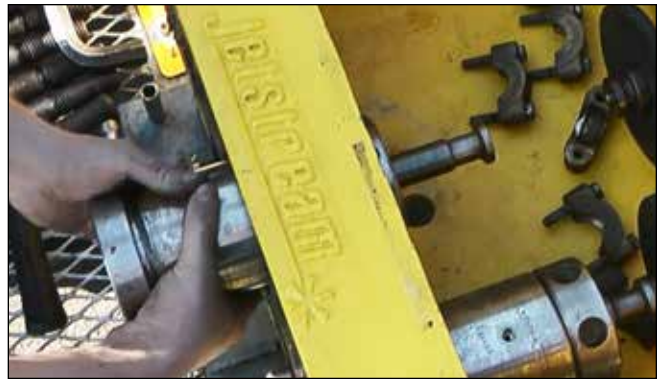
Figura 29: Remoción del prensaestopas.
