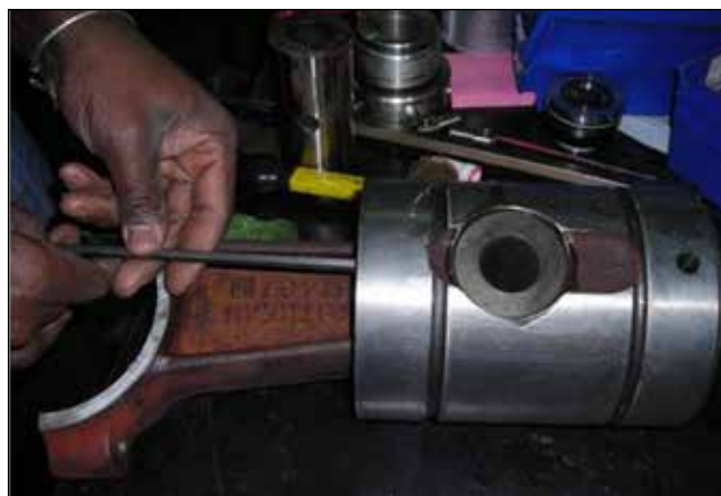
Figura 121: Extracción de los tornillos de fijación.
