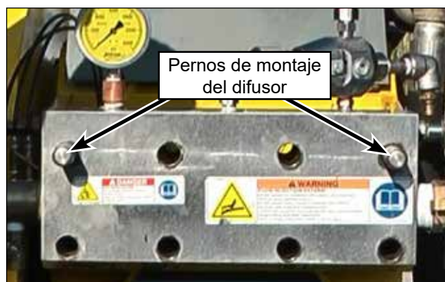
Figura 33: Levante el nuevo difusor sobre los pernos de montaje.
