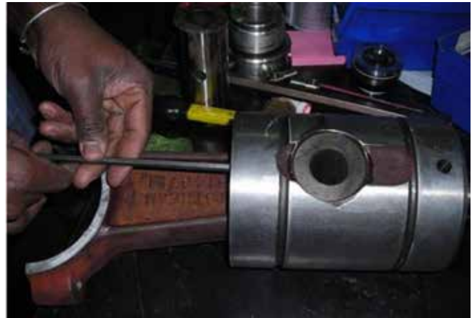
Figura 124: Instalación del segundo tornillo de fijación.
