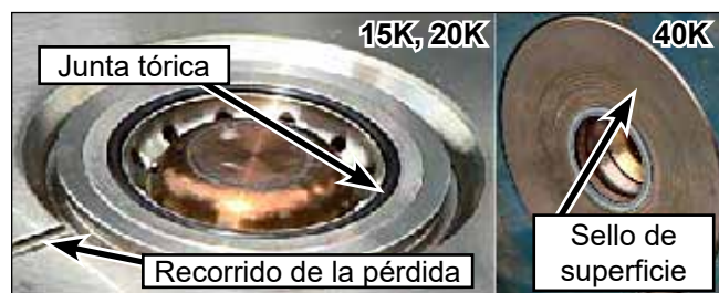
Figura 12: Sellos de la uni-valve al prensaestopas
