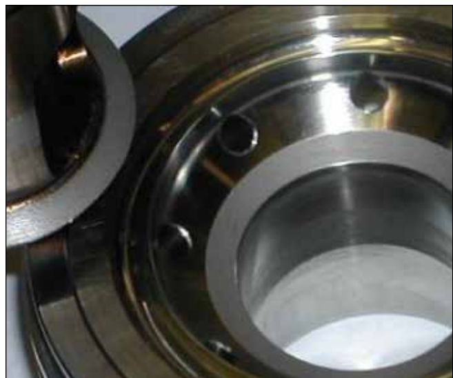
Figura 92: Asientos de válvulas solapados adecuadamente.
