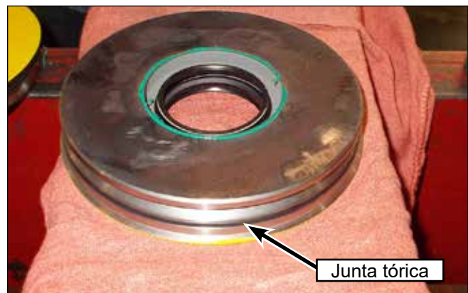
Figura 106: Instalación de la junta tórica.
