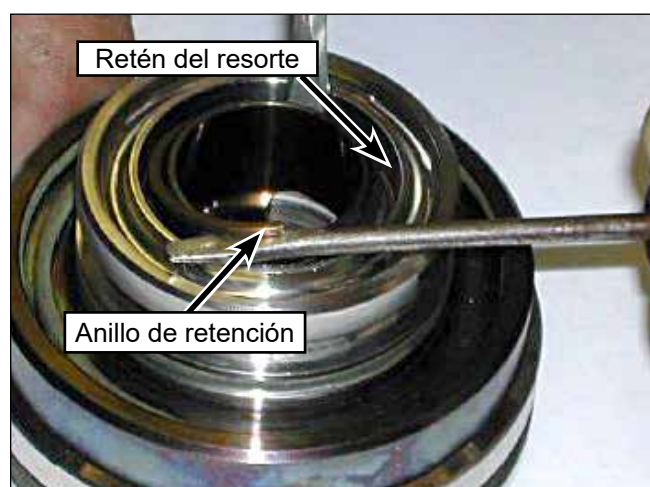
Figura 74: Extracción del anillo de retención.
