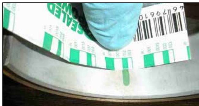
Figura 114: Medición del calibrador plástico.
