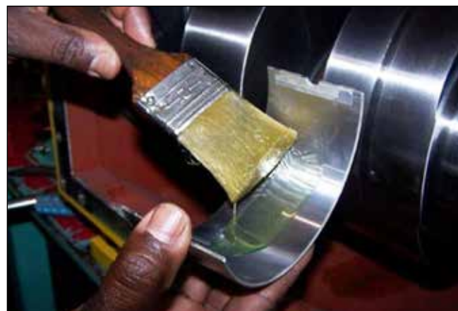
Figura 115: Lubricación del cojinete.
