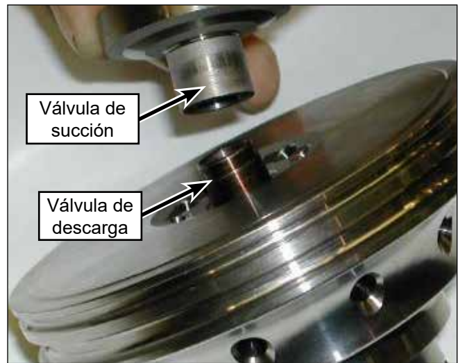
Figura 85: Extracción de las válvulas.
