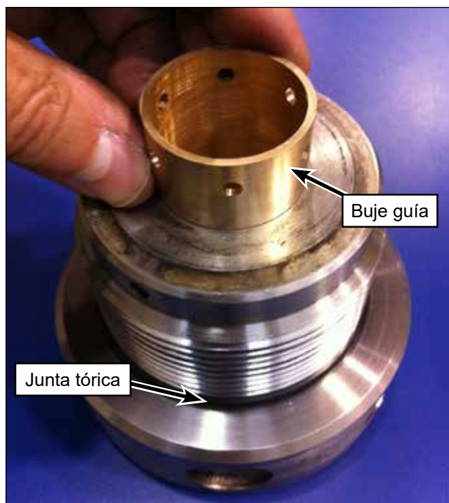
Figura 57: Instalación del buje guía.
