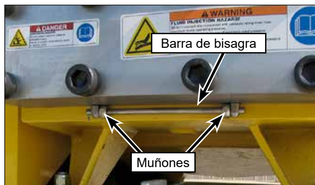
Figura 65: Barra de bisagra y muñones.
