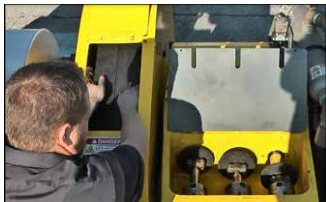
Figura 48: Rotación de la correa de transmisión.
