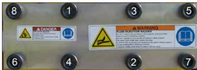
Figura 69: Secuencia de ajuste.
