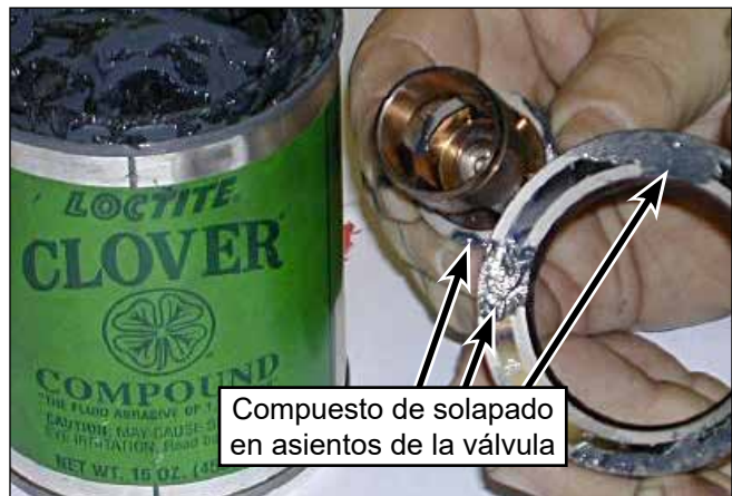
Figura 91: Ejemplo típico de aplicación del compuesto de solapado.
