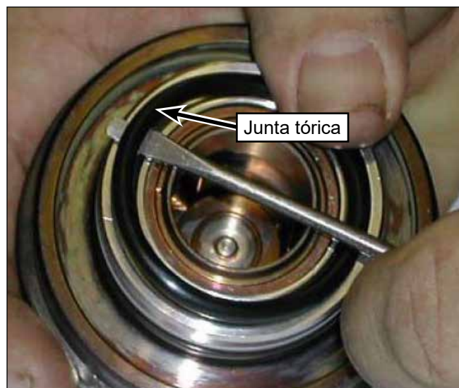
Figura 72: Extracción de la junta tórica.
