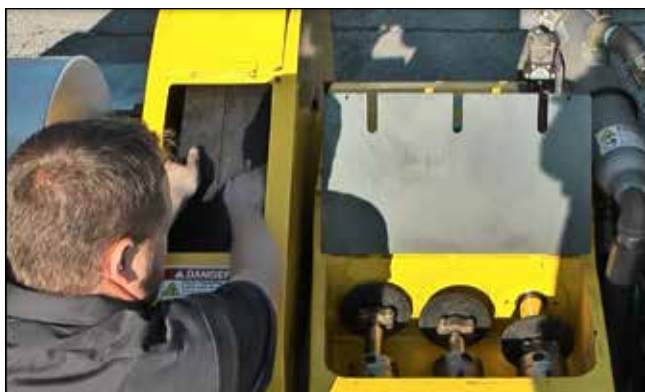
Figura 99: Rotación de la correa de transmisión.
