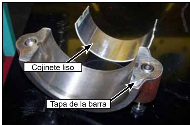
Figura 111: Extracción del cojinete.
