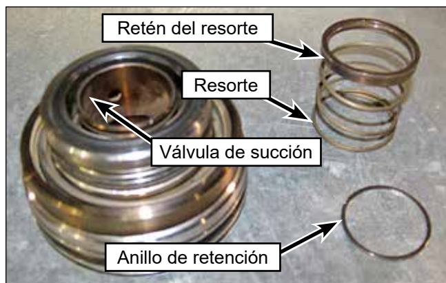
Figura 75: Extracción del anillo y el resorte de retención.
