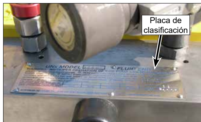
Figura 5: Placa de clasificación del extremo hidráulico.
