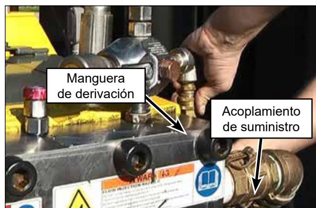
Figura 39: Conexión de la manguera de derivación y del acoplamiento de suministro.
