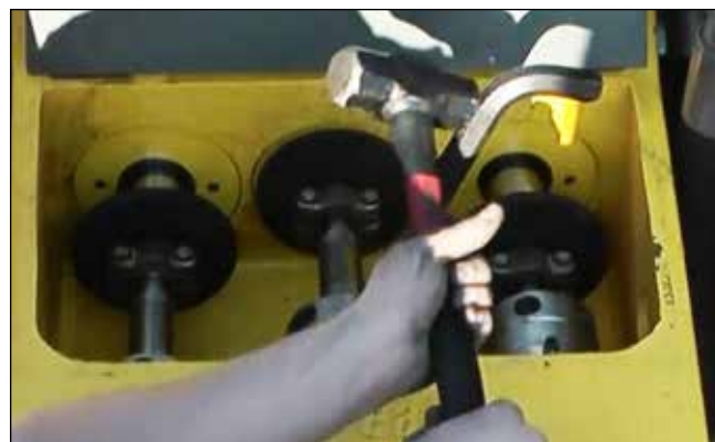
Figura 49: Aflojamiento de la tuerca hueca.
