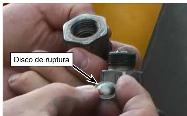
Figura 47: Extracción de discos.
