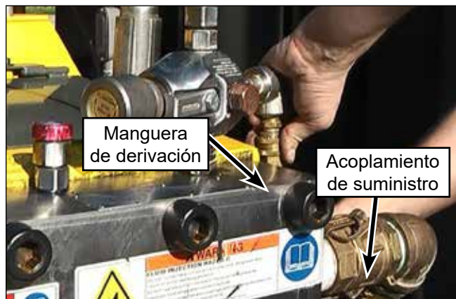
Figura 71: Conexiones de la manguera.
