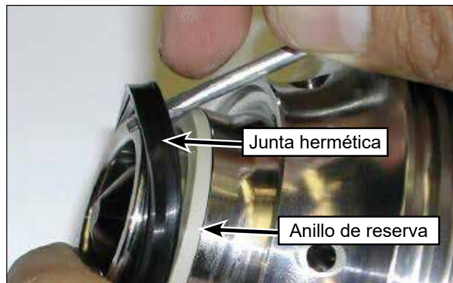
Figura 83: Extracción de la junta hermética.
