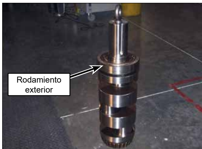
Figura 135: Instalación de pistas exteriores.
