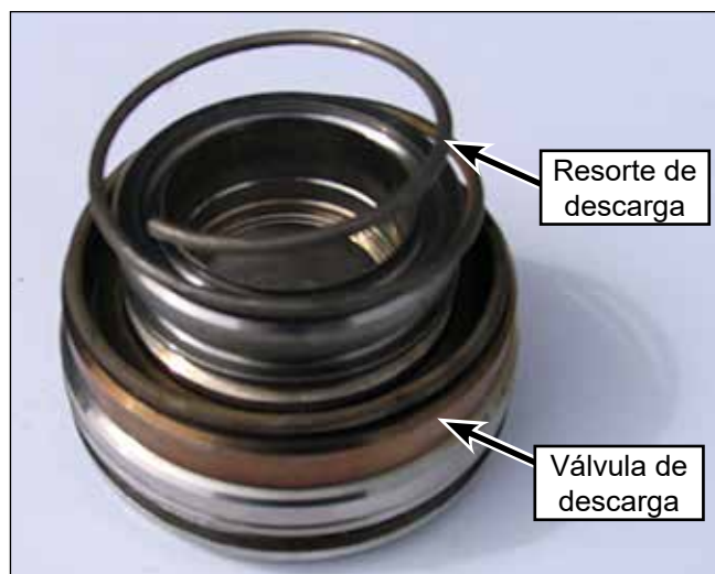
Figura 78: Instalación de descarga.
