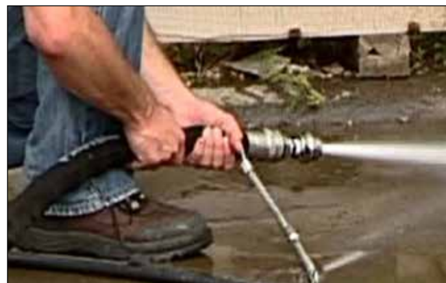
Figura 8: Enjuague de la manguera de descarga
