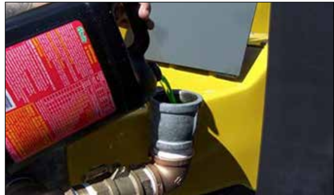
Figura 15: Agregado de anticongelante
