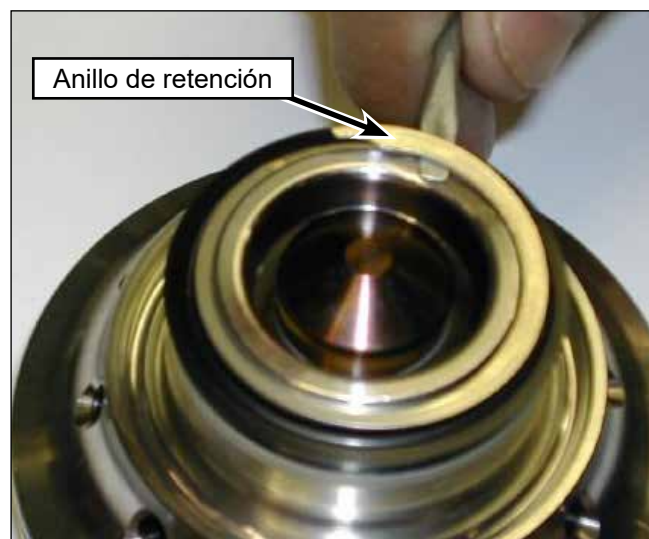
Figura 82: Extracción del anillo de retención.
