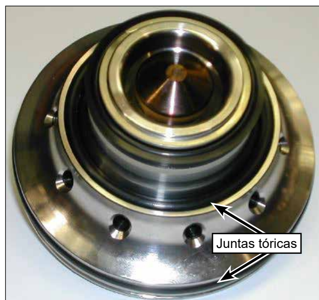
Figura 89: Instalación de las juntas tóricas.
