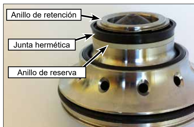
Figura 88: Instalación del anillo de sello.
