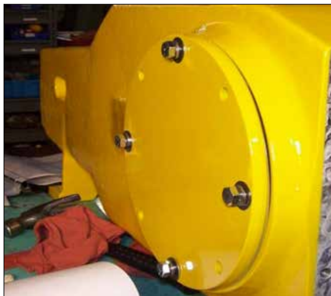
Figura 139: Instalación de la placa lateral.
