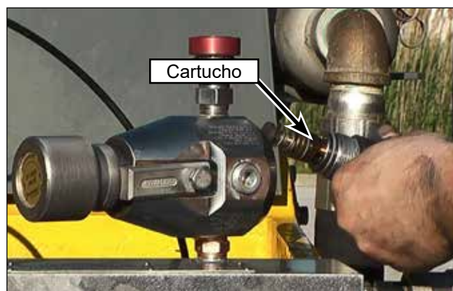
Figura 95: Extracción del cartucho.
