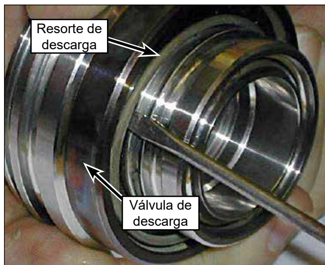
Figura 76: Extracción del resorte y la válvula de descarga.
