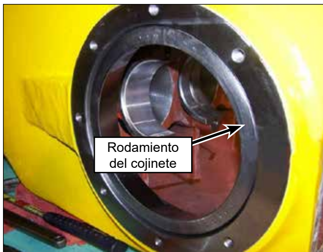
Figura 136: Instalación de pistas de cojinetes.
