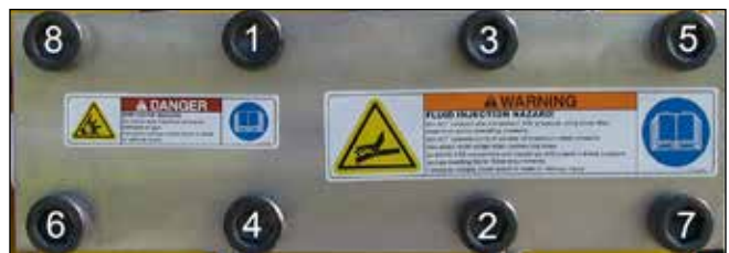
Figura 37: Secuencia de ajuste.
