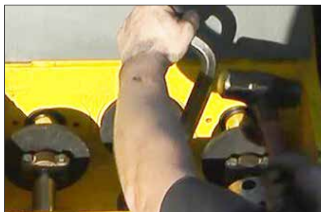
Figura 45: Ajuste de la tuerca hueca.
