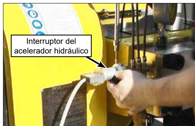
Figura 20: Interruptor del acelerador hidráulico.
