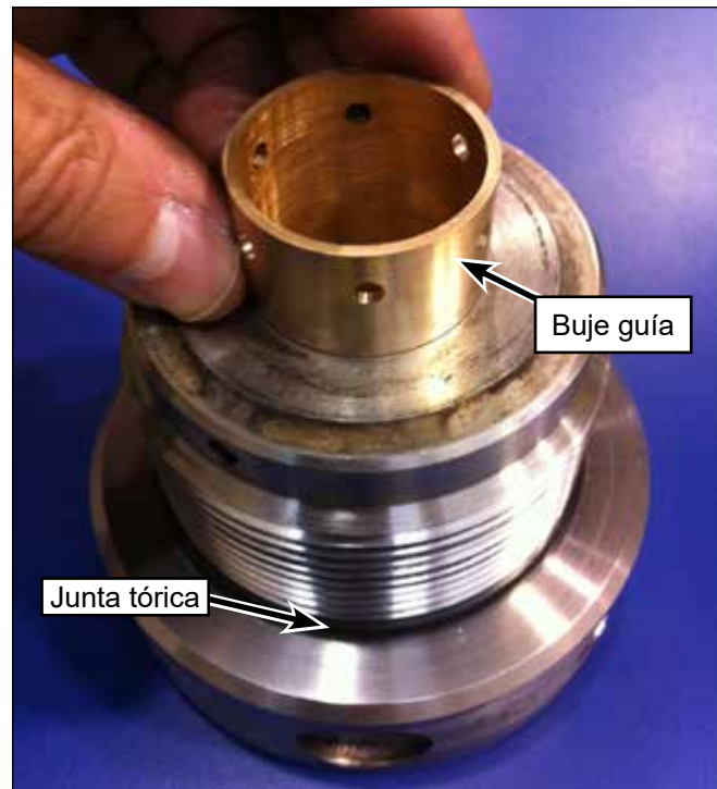
Figura 52: Extracción de buje guía (tuercas huecas para unidades de 15K/20K).
