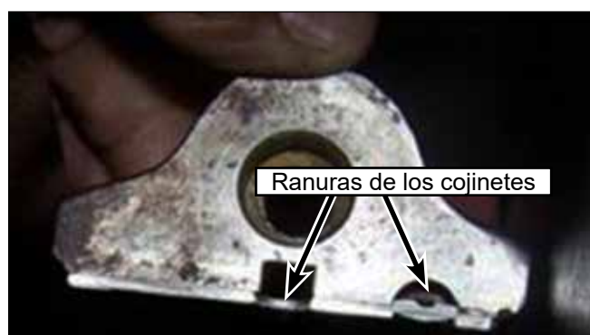
Figura 117: Ranuras de los cojinetes.
