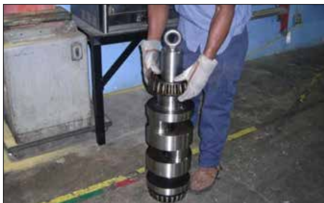
Figura 134: Instalación de cojinetes.
