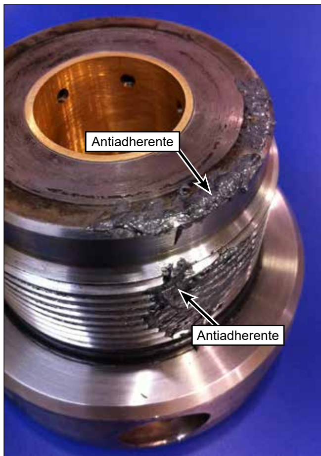
Figura 58: Aplicación de antiadherente.
