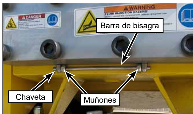
Figura 23: Barra de bisagra, muñones y chaveta.
