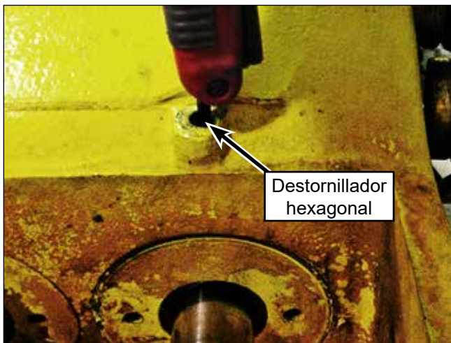
Figura 101: Acceso a los tornillos de fijación.
