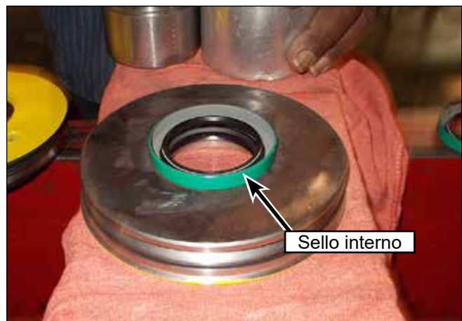
Figura 105: Instalación del sello interno.
